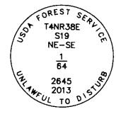
SET 3 1/4" ALUMINUM CAP ON 3"X36" ALUMINUM PIPE MARKED AS SHOWN
