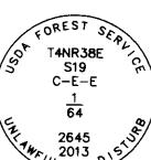
SET 3 1/4" ALUMINUM CAP ON 3"X36" ALUMINUM PIPE MARKED AS SHOWN
