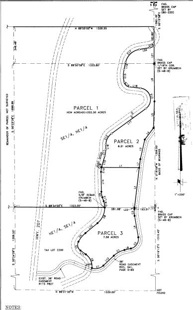
BASIS OF BEARING IS THE EAST LINE OF THE SE 1/4, NE 1/4 OF SECTION 5, TOWNSHIP 3 NORTH, RANGE 28 EAST, AS SHOWN ON RECORD SURVEY NO.
