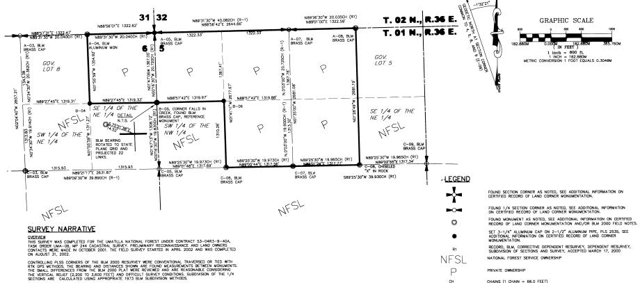
FOUND DISTANCE ARE GRID STATE PLANE DISTANCES. THE COMBINED FACTOR (GRID AND SCALE) FOR THIS PROJECT USING A MEAN ELEVATION OF 2800' IS 0,99978. MULTIPLY FOUND DISTANCE BY 1.00022 TO OBTAIN A GROUND DISTANCE, RECORD DISTANCES ARE GROUND.
